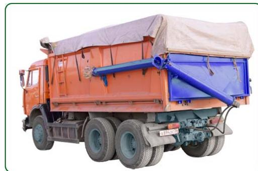
Загрузчик сеялок ЗС-20, установленный на КаМАЗ
