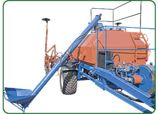
Для модернизации бункеров посевных комплексов или замены их штатных (отслуживших свой срок) загрузчиков бункеров мы предлагаем шнековые загрузчики на шарнире, аналогичные загрузчикам бункеров сеялок «ДОНЭЙР» и посевных комплексов «ПРОГРЕСС», длиной от 4 м до 8 м.
