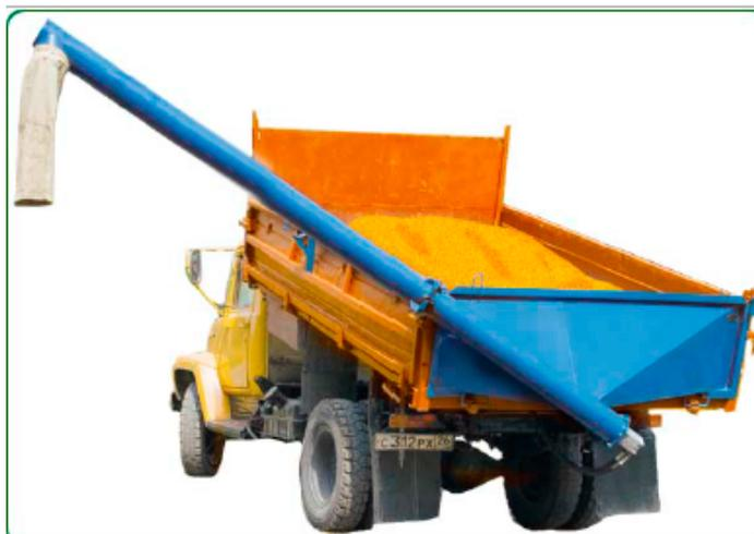
Подача зерна в шнековое устройство осуществляется через отверстие борта подъемом кузова транспортного средства.
