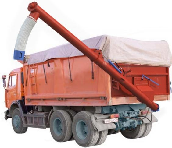
Шнек для загрузки и выгрузки бункера
