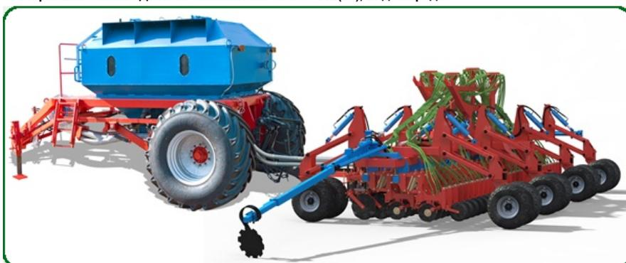
Стерневая сеялка «ДОНЭЙР-МиниТилл» 975/60-V12(15), вид сбоку
