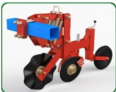
Волнистый (колторный) диск диаметром 460мм расположен на двудисковом сошнике диаметром 373мм с давлением 80-160 кг для прямого сева или при минимальной обработке почвы
