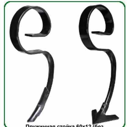
Пружинная стойка 60x12 (без подпружинника) с долотом 60x260x6 и лапой 200x6
