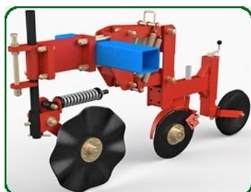
Волнистый (колторный) диск диаметром 510мм давлением 70-80 кг расположен на одной оси с двудисковым сошником диаметром 373мм с давлением 80-160 кг для прямого сева при очень тяжелых условиях. Функциональный аналог сошника серии 10ND (GREAT PLAINS)
