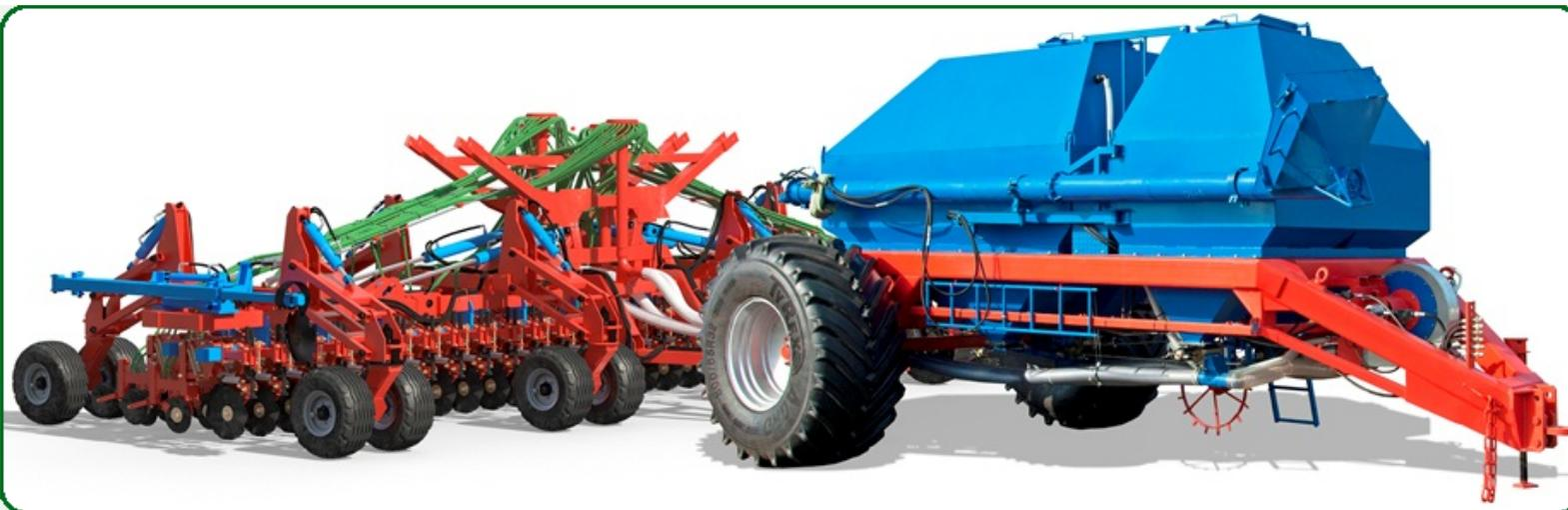
Сеялка прямого сева Донэйр-НТ II 1050/56-V12(19)
