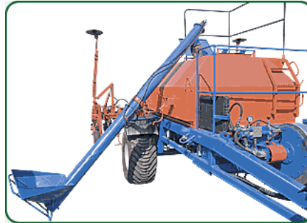
Шнек в режиме загрузки бункера
