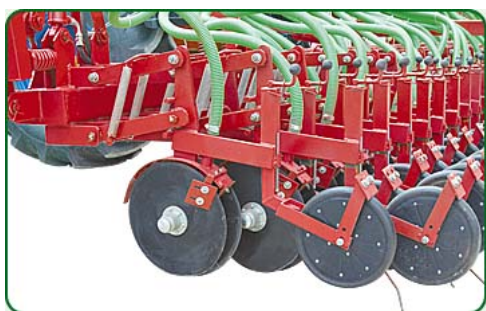
Усиленный двудисковый сошник диаметром 373 мм давлением до 45 кг со смещением дисков, с прикатывающим колесом диаметром 330 мм. На ступице надежный двухрядный подшипник FKL с герметичной защитой.
