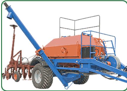
Шнек в режиме выгрузки бункера
