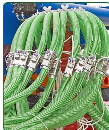
Распределитель семян с датчиками забивания семяпроводов бортового компьютера «АХМ-контроль»
