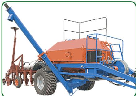
Шнек в режиме выгрузки бункера
