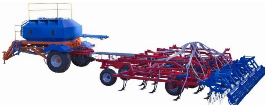
В комплектацию каждого вида ПК входят, помимо высевающих лап, и рабочие органы, входящие в комплект поставки культиваторов, – лапы 260, 310 мм и долото 45х16х270 мм, 50х15х360 мм, для того, чтобы использовать культиваторную часть посевного комплекса отдельно, для выполнения разнообразных полевых работ. В том числе для 20-30 см глубокого (адресного) внесения минеральных удобрений, например, под сахарную свеклу.
