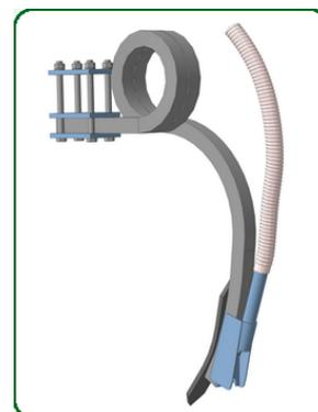
Пружинная стойка глубокорыхлителя 30x30 с трубкой для подачи сыпучих удобрений на глубину 20-25 см или для ПРЯМОГО сева зерновых на глубину 2-6 см.
