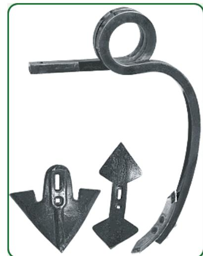
Традиционная система обработки почвы: двупружинная стойка 40x40 с рабочими насадками:
