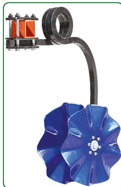
Двупружинная стойка 40x40 с парой колторных дисков 520 мм OFAS, расстояние между дисками 30 см, шаг 15 см
