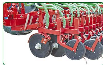
Усиленный двудисковый сошник давлением 40-70кг со смещением дисков. На ступице надежный двухрядный подшипник с прекрасной защитой от пыли и влаги
