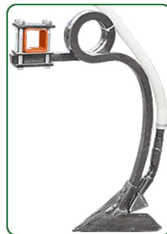
Посевная лапа 360 мм, установленная на двуспиральную стойку 40x40 для раздельного внесения удобрений с расположением их под семенами. Обеспечивает перекрытие 11 см и 18 см сплошную полосу (ленту) семян
