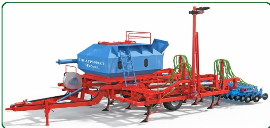
Вариант размещения колторных (волнистых) дисков для прямого сева на модели «АГРИФЕСТ-Гибрид» МПК 02-1050/72-V12(15)
