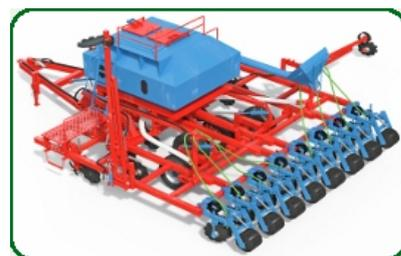
Модификация ПК для линейного рыхления на 8 рядов с внесением удобрений на глубину 15-20см, подробнее смотрите страницу [«АГРИВАТОР-Комби»](#)
