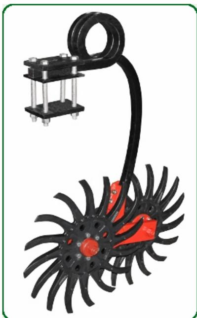
Стойка с игольчатыми дисками. На пружинной стойке можно установить литые игольчатые диски на тандеме (по типу БИГ-3) на 16 лучей и получить тяжелую игольчатую борону-мотыгу. Диски можно переворачивать для увеличения воздействия на почву.
