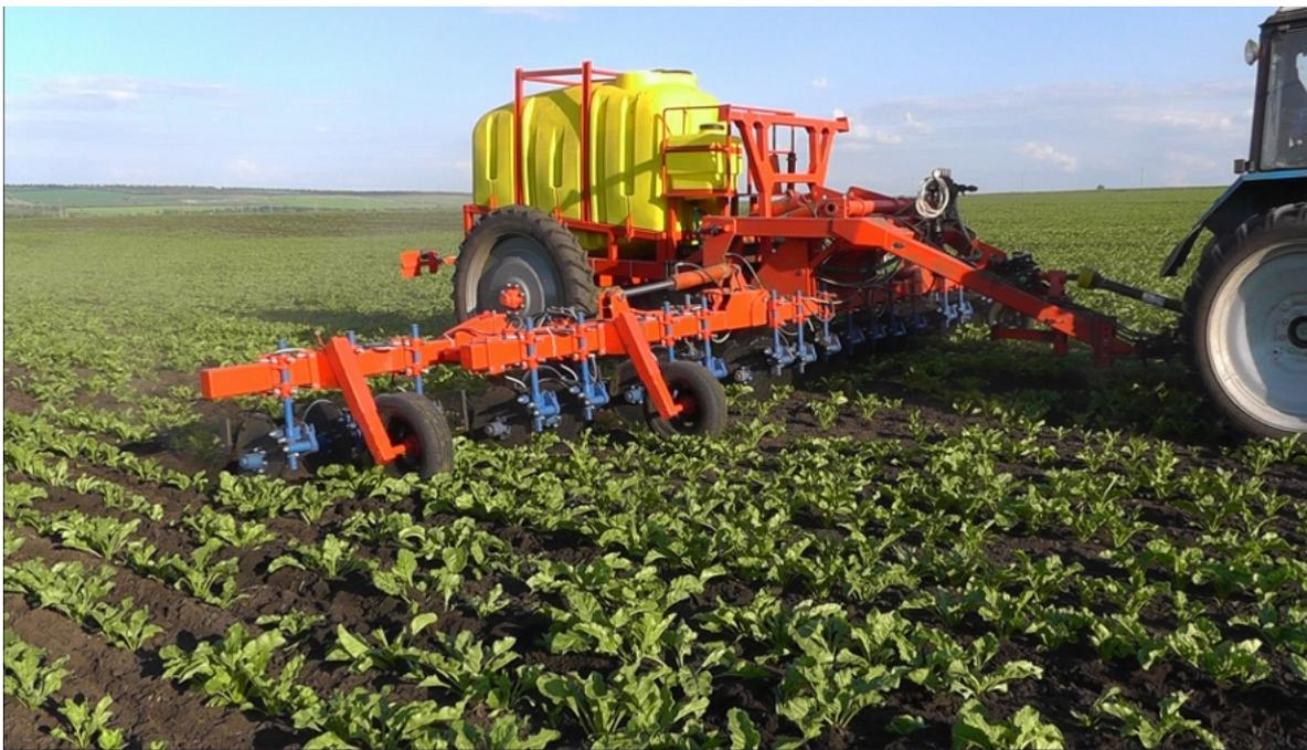
Агрегат (растениепитатель, аппликатор) ПЖУ-4000/25/12 для внесения в почву жидкое минеральное удобрение карбамидно-аммиачная смесь (КАС 32), жидкое комплексное удобрение (ЖКУ), аммиачной воды
