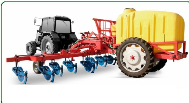
Инъекционный растениепитатель ИКП-12048/4 с широкопрофильными колесами от К-701 предоставленными покупателем (мы изготовили переходной фланец - диск)
