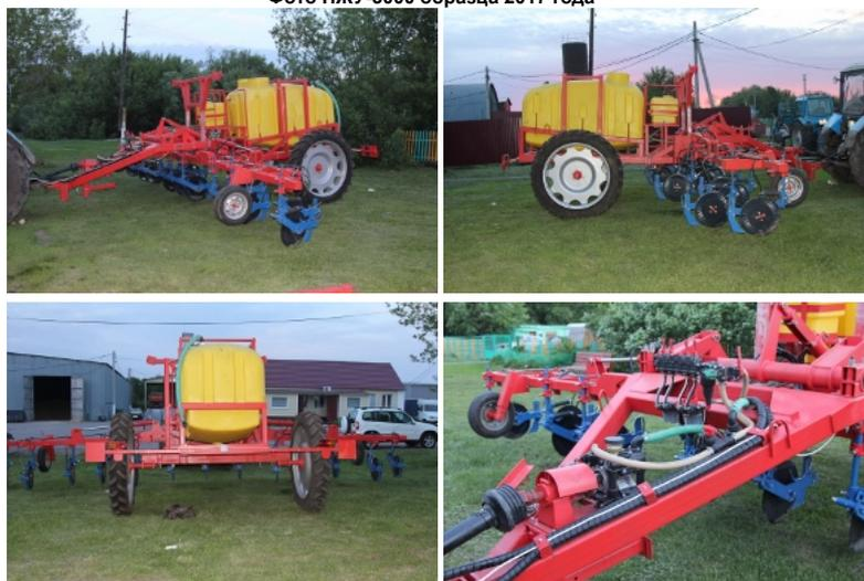
**Пропашной (рядковый) культиватор «АГРИФЛЕКС» КРН-5,6/70-Ж(600) с ёмкостью 600л для внесения КАС-32, ЖКУ, аммиачной воды**
