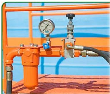
Регулирование оборотов гидромотора
