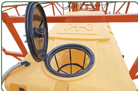
Крышка с дыхательным клапаном и сетчатым фильтром горловины
