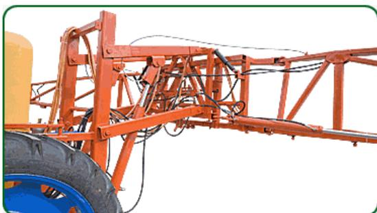
Узел подъема-опускания и амортизации штанг
