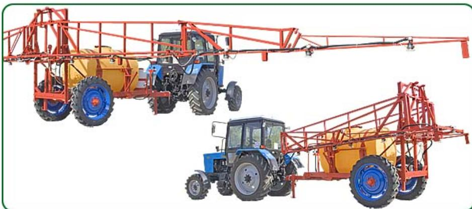
Опрыскиватель «ПАТРИОТ» ОП-2000/21, оснащенный малообъемной системой опрыскивания
