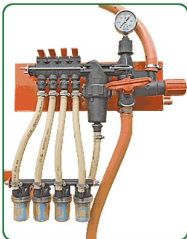
Блок клапанов пропорционального расхода и дополнительная фильтрация каждой секции
