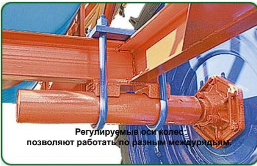
Регулируемые оси колес позволяют работать по разным междурядьям.
