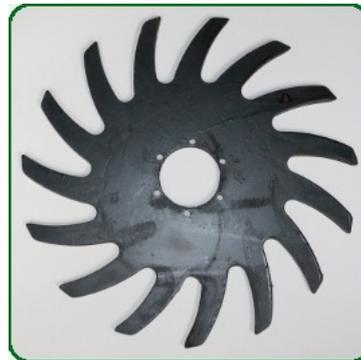
Диск роторного очистителя рядка диаметром 330 мм толщиной 10мм из легированной стали, форма лучей с изгибом по радиусу для минимального рыхления почвы
