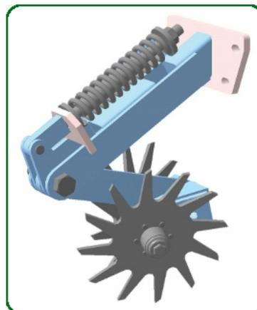
Очиститель Ø 330 мм с пружинной защитой
