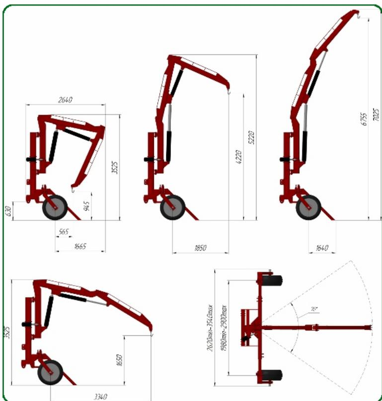
Манипулятор (погрузчик, подъемник) с колесами МГН-1400К слева и Манипулятор с колесами и поворотной стрелой МГН-1400КП справа
