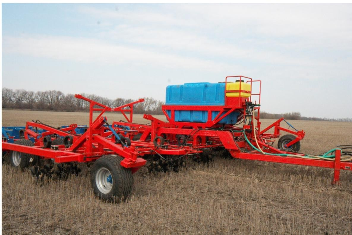
Турбодисковый культиватор "Агрифест-Экспресс" шириной 9,2м с емкостью 2500л для внесения жидких удобрений
