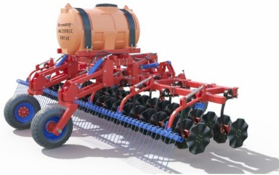
Трансформер-«ЭКСПРЕСС» 6м с емкостью 1000л и задними колесами
