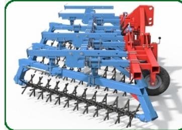
Цепной колючий модуль (РЗМ) с гибким валом может устанавливаться на любые почвообрабатывающие орудия
