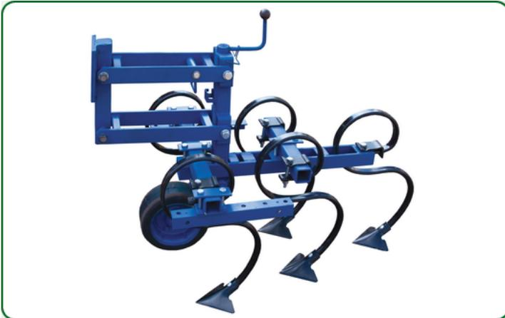
Секция на междурядье 70 или 45 см с пятью стойками может поставляться отдельно для модернизации имеющихся пропашных культиваторов под любую раму, в том числе «ЗУБОВАТОР» РЗБ-6Н.
