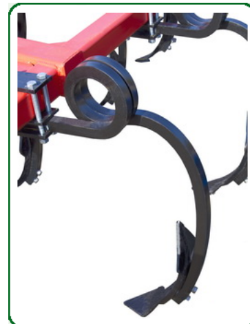
Двупружинная стойка 30x30 с двухсторонним сердцевидным наконечником.
