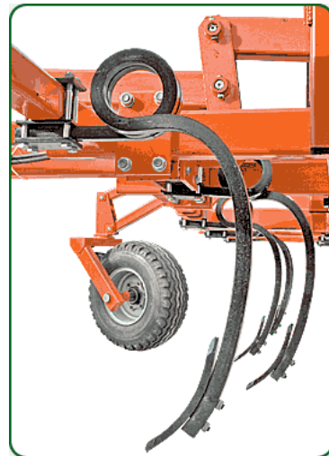
Основная обработка почвы: стойка с двусторонним наконечником 40х16х270 мм
