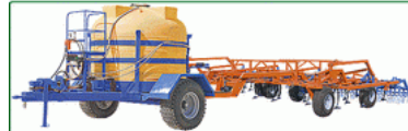
С помощью ПЗУ-4500 и культиватора «АГРИТОП» можно осуществлять внесение комплексных жидких удобрений и аммиачной воды.
