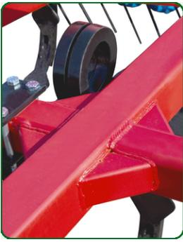
Угловые усиления рамы с помощью закрытых косынок позволяют получить высокую прочность рамы для экстремальных условий эксплуатации культиваторов.
