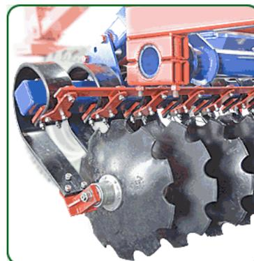
Регулировка угла атаки дисковых ножей
