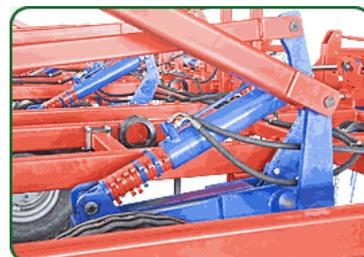
Регулировка глубины обработки
