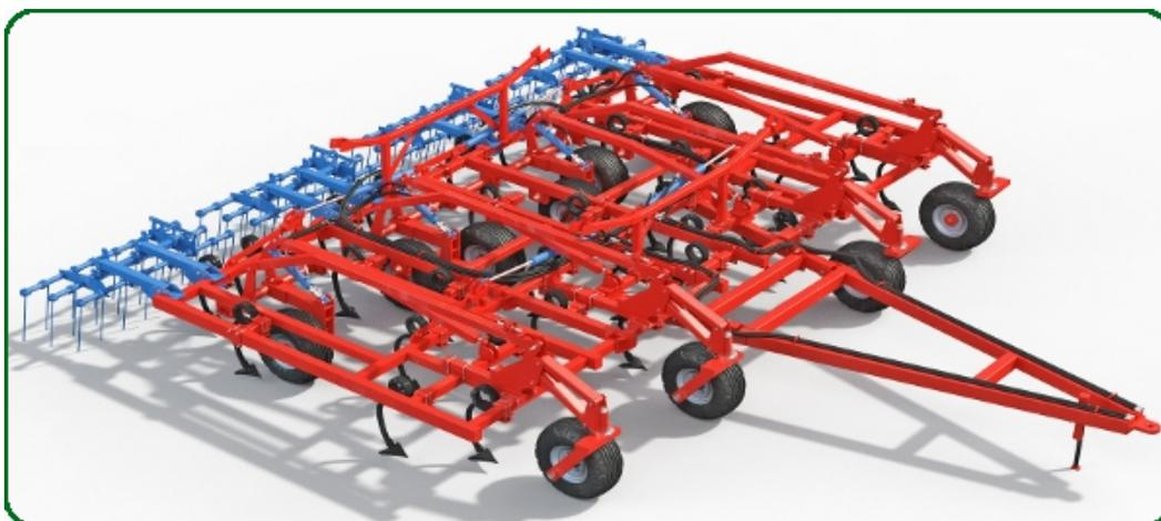
«АГРИФЕСТ» имеет более мощную и очень тяжелую раму из стали 09Г2С и более крепкие стойки большего размера, по сравнению с тяжелым культиватором «АГРИТОП», для работы в более тяжелых условиях по стерне и для разноглубинной обработки до 30 см долотом или до 20 см лапой. Может применяться как полевой культиватор при засухе, при запущенных парах и других тяжелых условиях с соответствующими лапами. Это современное орудие для безотвальной основной обработки почвы.
