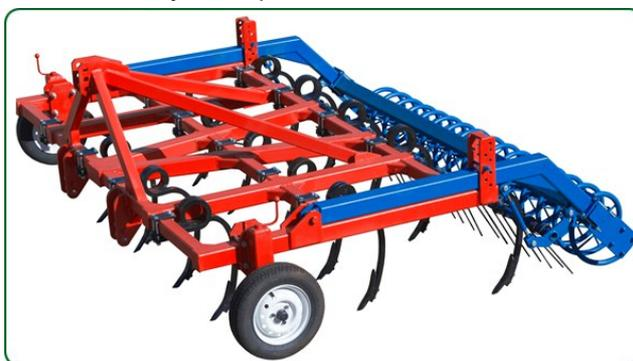
Может применяться для внутривспашечного внесения жидкого навоза с емкостью «АГРИТОН» или для глубокого внесения минеральных удобрений с ПВБ.
