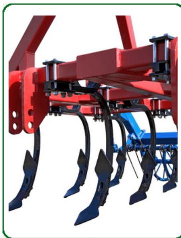
Двухпружинная стойка 30x30 с двухсторонним сердцевидным наконечником.
