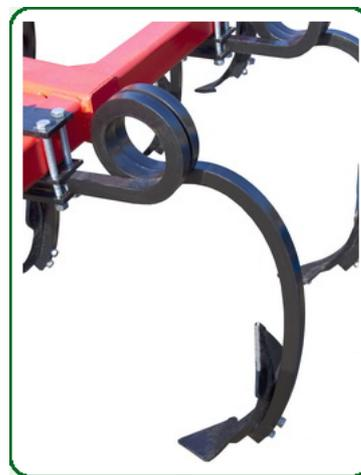
Двухпружинная стойка 30x30 с двухсторонним сердцевидным наконечником.
