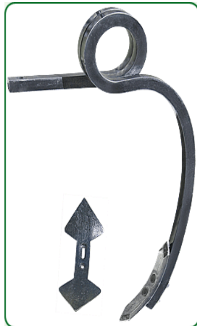
Двупружинная стойка 40x40 BIANCHI : интегрированная защита от камней, вибрирующий эффект обеспечивает самоочистку, препятствует забиванию и отлично втягивает в почву.
