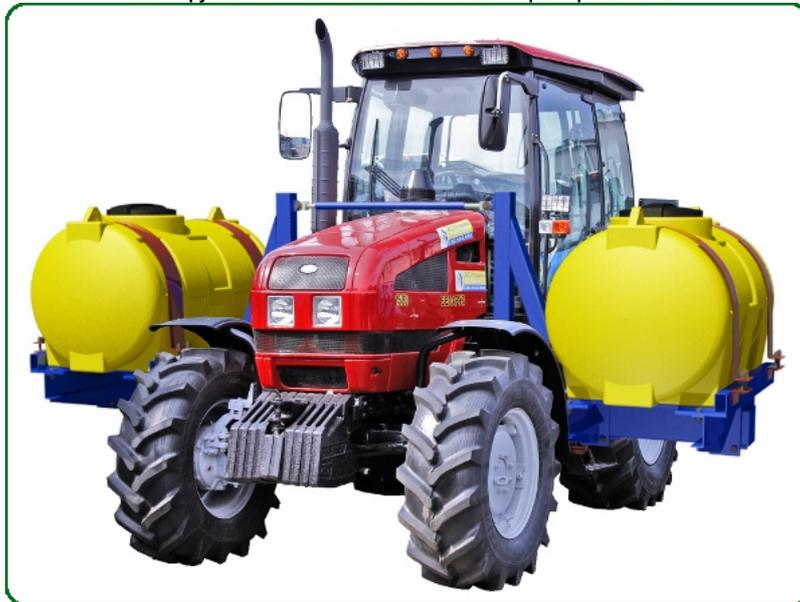
Парные ёмкости «АГРИМОНТ» для тракторов со спаренными колесами
