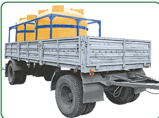
Кассета 4500x2, размещенная в прицепе. Кассеты могут перевозиться в автоприцепах или тракторных тележках.
