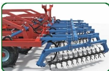
Новый тип рабочих органов Роторно-зубовые модули (РЗМ) можно использовать практически на любых почвообрабатывающих орудиях для финишной подготовки почвы.
