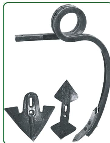
Третий вариант - использование пружинной стойки 40х40 чизельного плуга (стерневого культиватора «АГРИФЕСТ») для вертикальной или основной традиционной обработки почвы. Высота и присоединительные размеры к раме стойки дискатора и культиваторной стойки - одинаковые и легко выполнимые.
