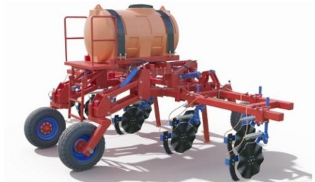
Для подкормки пропашных культур может быть переоборудован «ИГЛОВАТОР-Трансформер-ПЖУ» с емкостью 1000л
