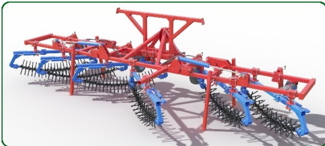
Специально под трактор МТЗ-82 разработана облегченная модель Зубоватора шириной 6м с рамой из профильной трубы 80x80x6. А для ранневесенних работ по переувлажненной почве можно установить дополнительную пару опорных колес (опция).
