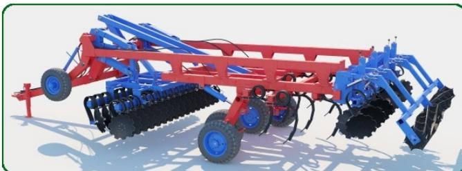
С измельчением и заделкой в верхнем слое почвы большого количества твердых остатков хорошо справились бы тяжелые и сверхтяжелые дисковые бороны, с нагрузкой на диск 120-145 кг. Однако глубокое рыхление дисковой бороней на глубину более 10 см становится очень затратным действием из-за резкого возрастания расхода ГСМ и усиленного износа дисков и подшипников. Наиболее рационально для глубокого рыхления использовать
